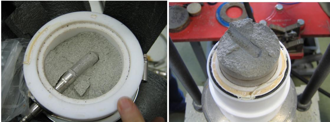
Figura 7.- Aspecto de las dos mitades de la columna de bentonita durante el desmontaje realizado para reemplazar el calentador a los 812 días de ensayo.
