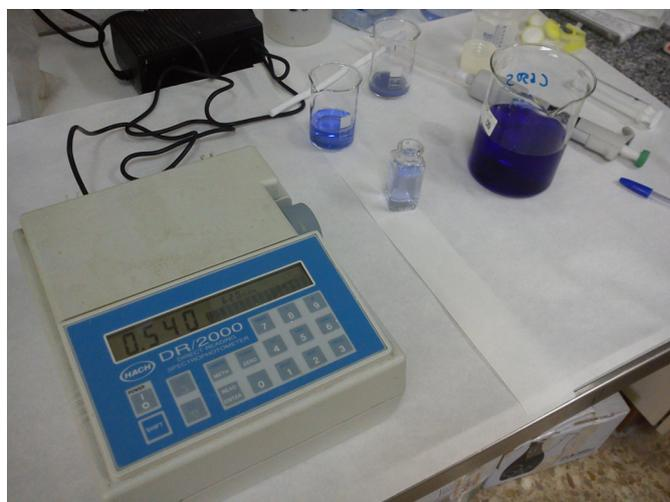
Figura 17.- Espectrofotómetro empleado para determinar la capacidad de intercambio catiónico.
