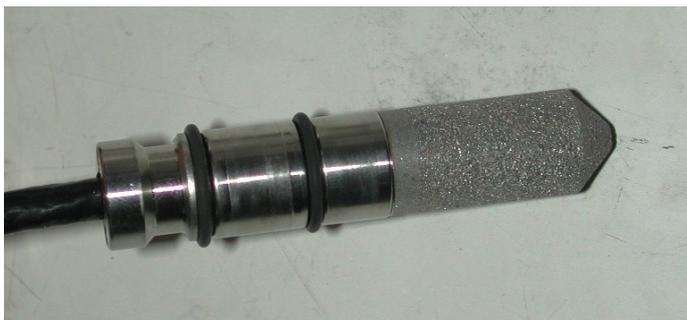
Figura 1.- Sensor utilizado para la medida de humedad relativa y temperatura
