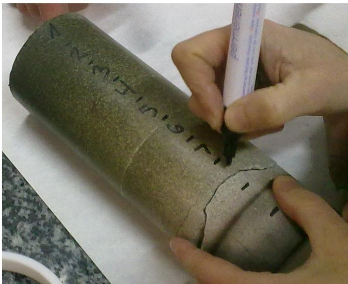
Figura 14.- Subsecciones de muestreo establecidas en la columna del ensayo TBT1500 al final del mismo.
