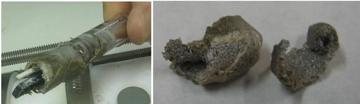
Figura 13.- Aspecto del sensor 3 y su filtro al final del ensayo.
