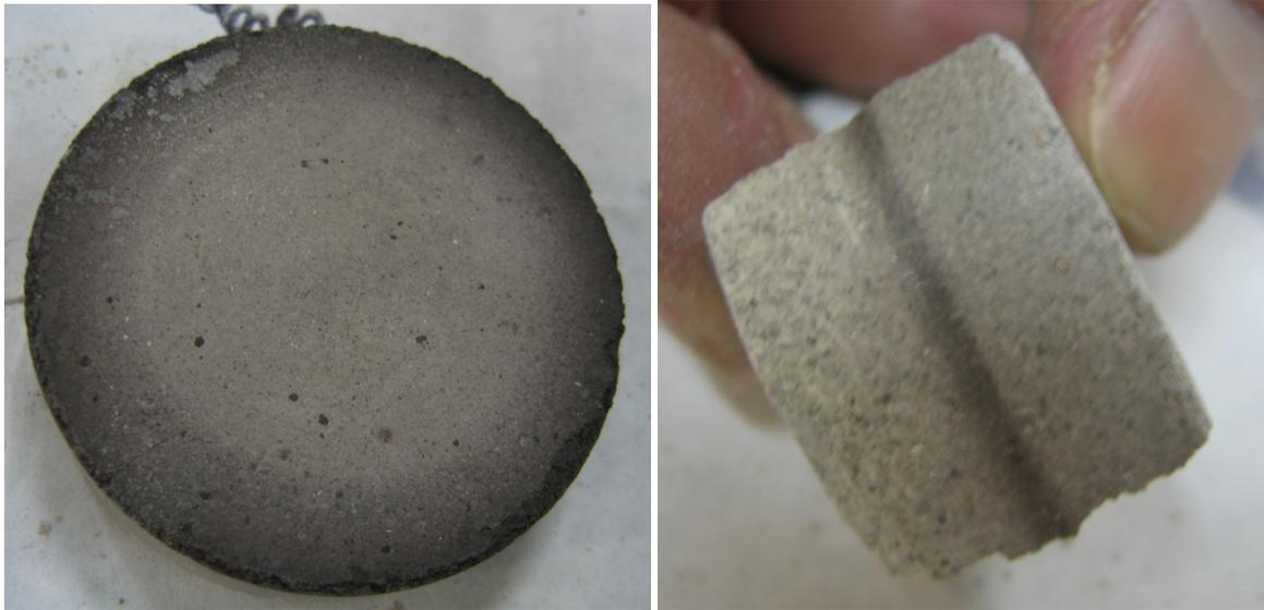
Figura 12.- Aspecto final de la superficie de bentonita en contacto con el calentador y de la sección de muestreo 9 (a 3 cm del calentador).
