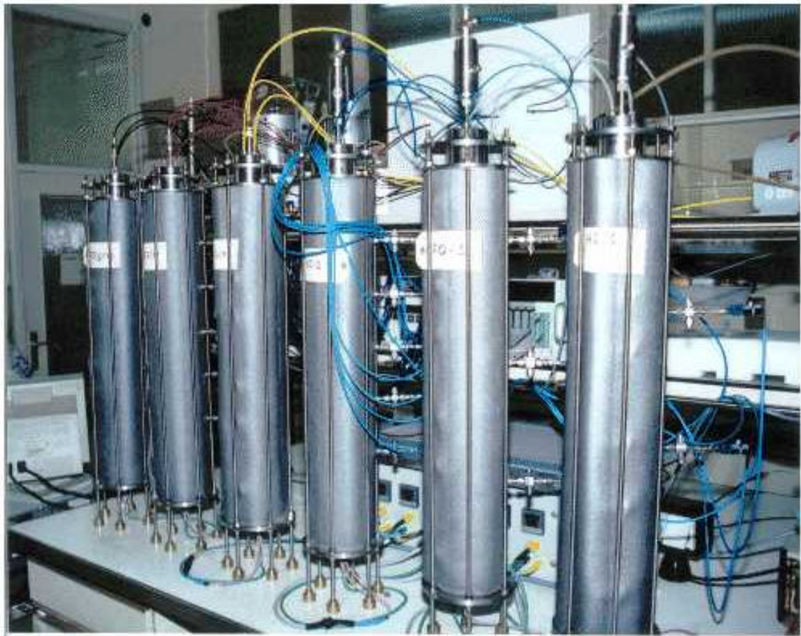
Figura 2: Aspecto de las celdas termo-hidráulicas en funcionamiento, las tres primeras con cámara de muestreo en el sistema de hidratación
