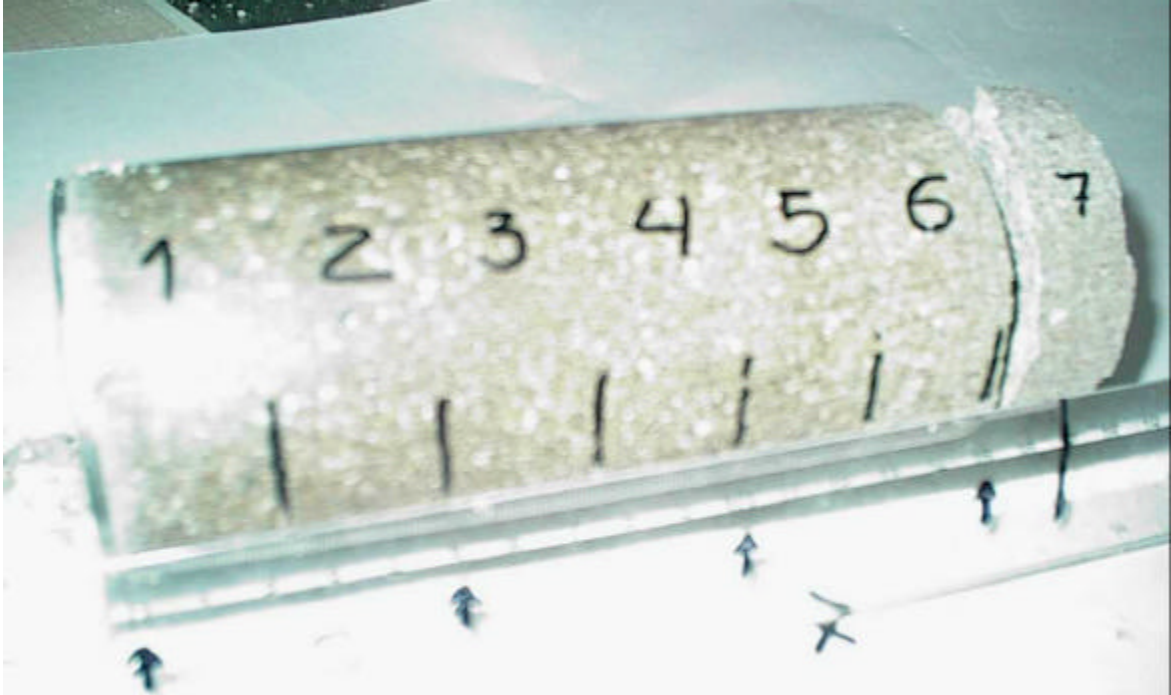
Figura 11: Aspecto del sellado de las dos probetas superiores del ensayo FQ1 (entre las secciones 4 y 5). La separación entre las secciones 6 y 7 es debida a rotura mecánica al extraer la probeta
