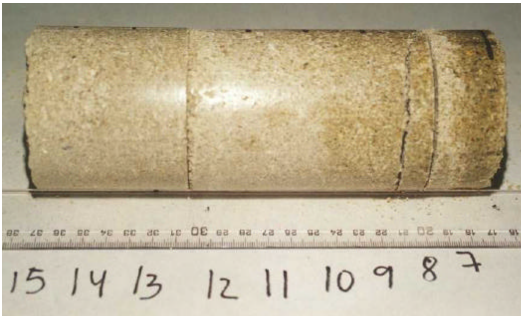
Figura 14: Aspecto de un fragmento de la probeta 2 (sección 7), probeta 3 (secciones 8 a 12) y un fragmento de la probeta 4 (secciones 13 a 15) tras el desmontaje del ensayo FQ2.
