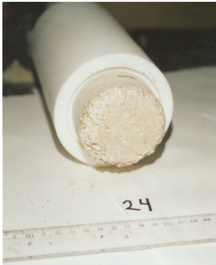
Figura 15: Aspecto de la bentonita en contacto con el calentador al desmontar el ensayo FQ2
