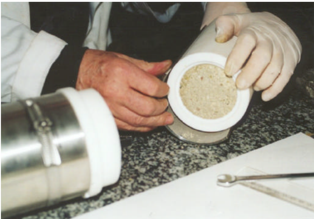
Figura 5: Separación de la coquilla de acero inoxidable para iniciar la extracción de la probeta de bentonita
