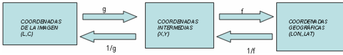
Figura 17. Esquema de transformación entre coordenadas de la imagen y coordenadas geográficas.
