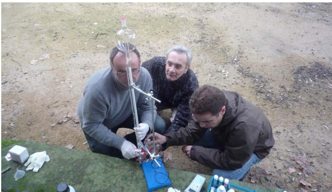
*Fig. 1. Medida de la alcalinidad en el campo*
