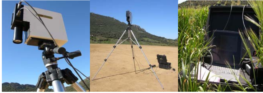
Figura 8. Medida radiométrica con el espectrometro de campo GER 3700.
