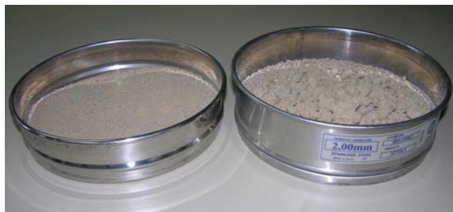
Figura 14. Muestra tamizada menor de 2 mm y fracción mayor de 2 mm.
