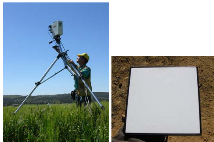
Figura 10. Medida del blanco con el panel Spectralon®.
