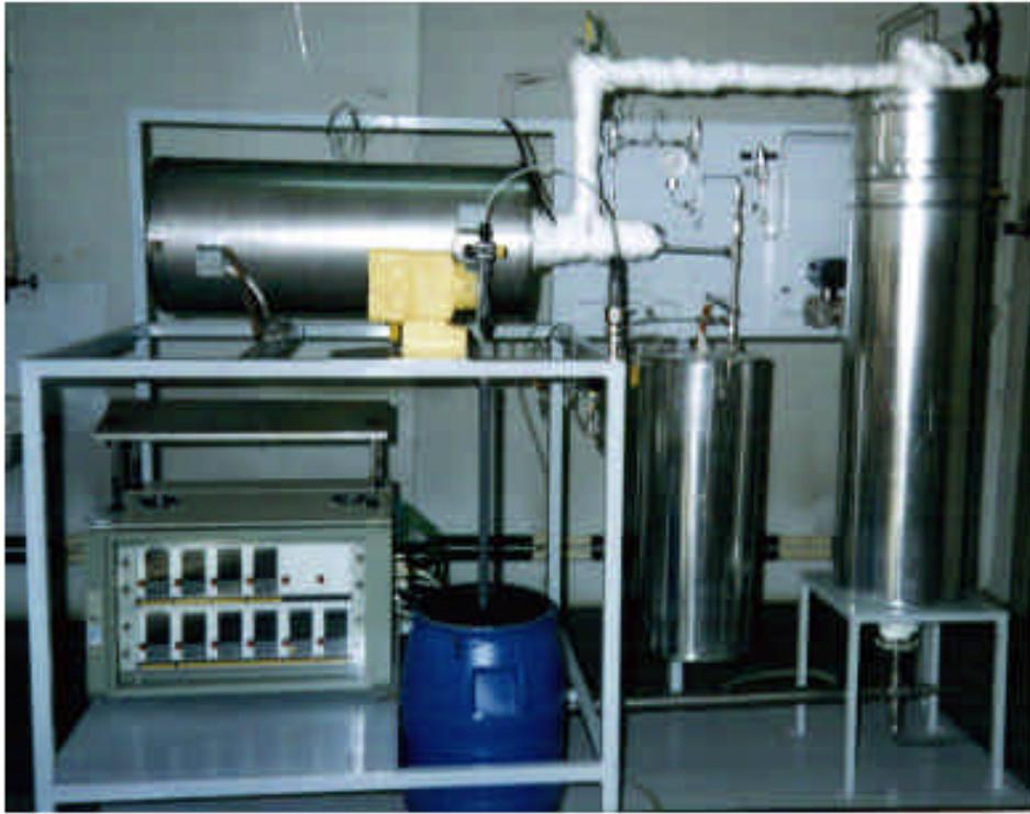
*Figura 8. Instalación de tratamiento de gases a alta temperatura y presión atmosférica.*
