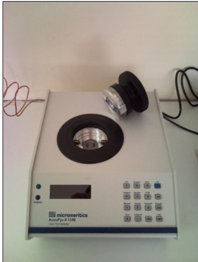
Foto 3.- Laboratorio de Caracterización Petrofísica del Ciemat. Picnómetro de Helio Accupyc 1340, Micromeritics.
