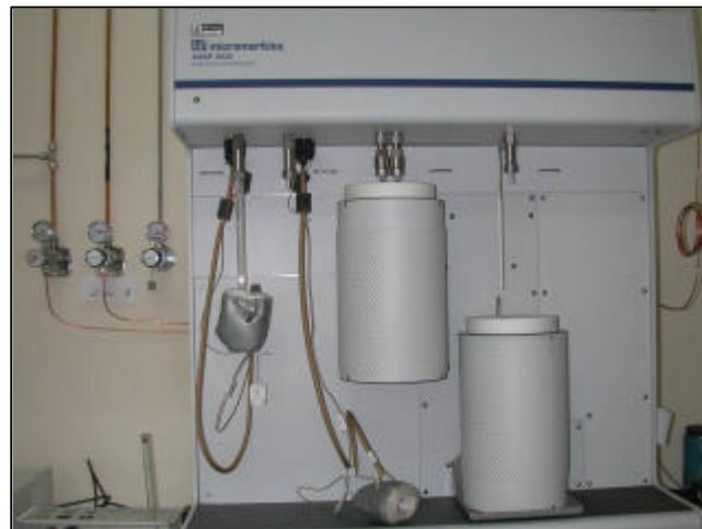
Foto 2.- Laboratorio de Caracterización Petrofísica del Ciemat. Equipo ASAP 2020 - Micromeritics
