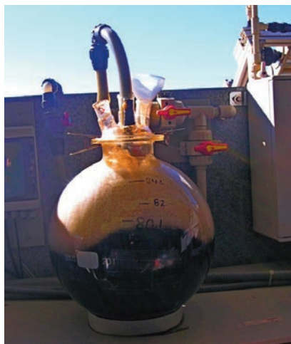
Tanque recirculación con aguas corcho (RITECA II). Recirculation Tank with Cork Water (RITECA II).
