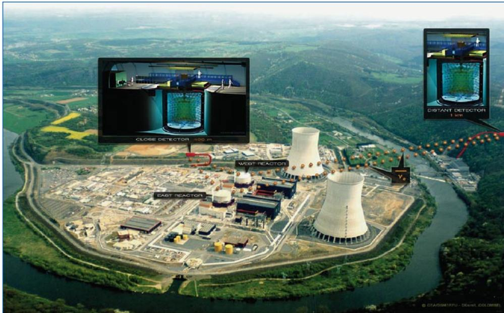
Figura 1. Vista de la central nuclear de Chooz en Francia y disposición de los detectores del experimento Double Chooz.
