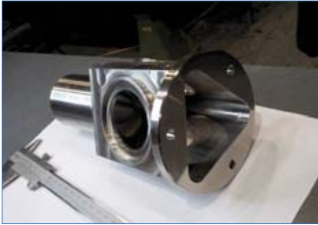
Celda óptica para contador de centelleo líquido TDCR. Optic cell for liquid scintillation counter TDCR.
