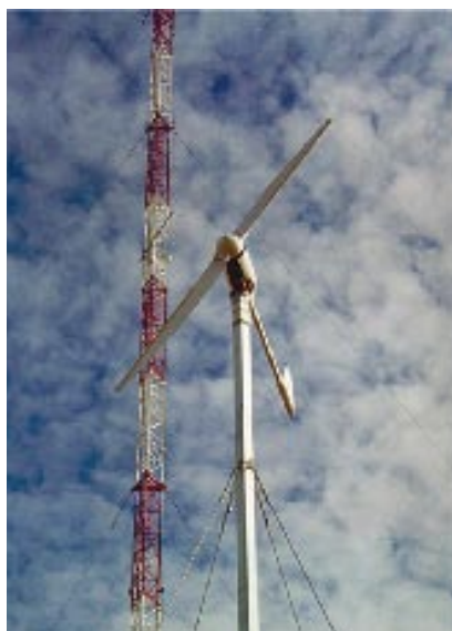
Aerogenerador en la planta de ensayos del CEDER. Wind turbine in the CEDER test plant.
