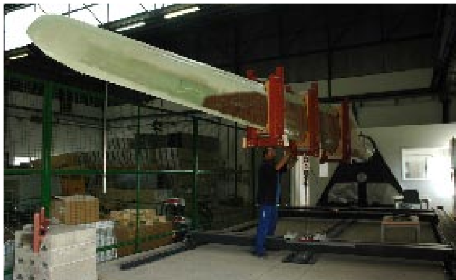
Ensayo con pala de aerogenerador de 100 kW. Test with 100 kW wind turbine blade.
