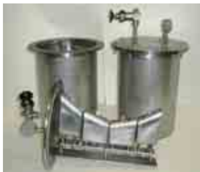
Una de las cabezas del limitador de litio líquido con los recipientes de transporte desde Moscú. One of the heads of the liquid lithium limiter with transport containers from Moscow.
