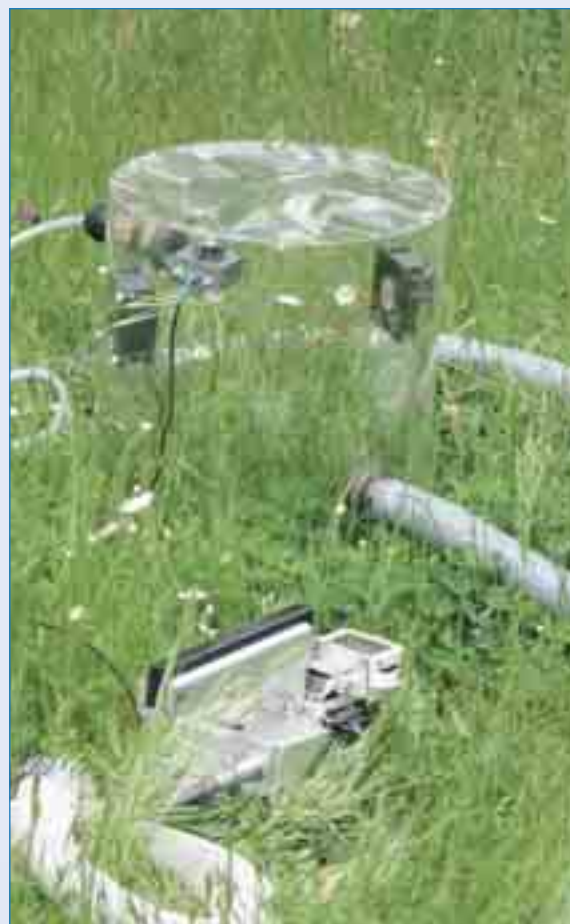
Figura 3: Equipos de medida de intercambio gaseoso a escala foliar y de dosel. Figure 3: Gaseous exchange measurement equipment at foliar and canopy scale.
