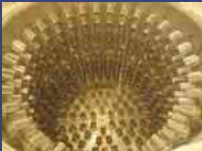
Dispositivos fotomultiplicadores en el centro del detector de Double Chooz. Photomultiplier devices in the center of the detector of Double Chooz.
