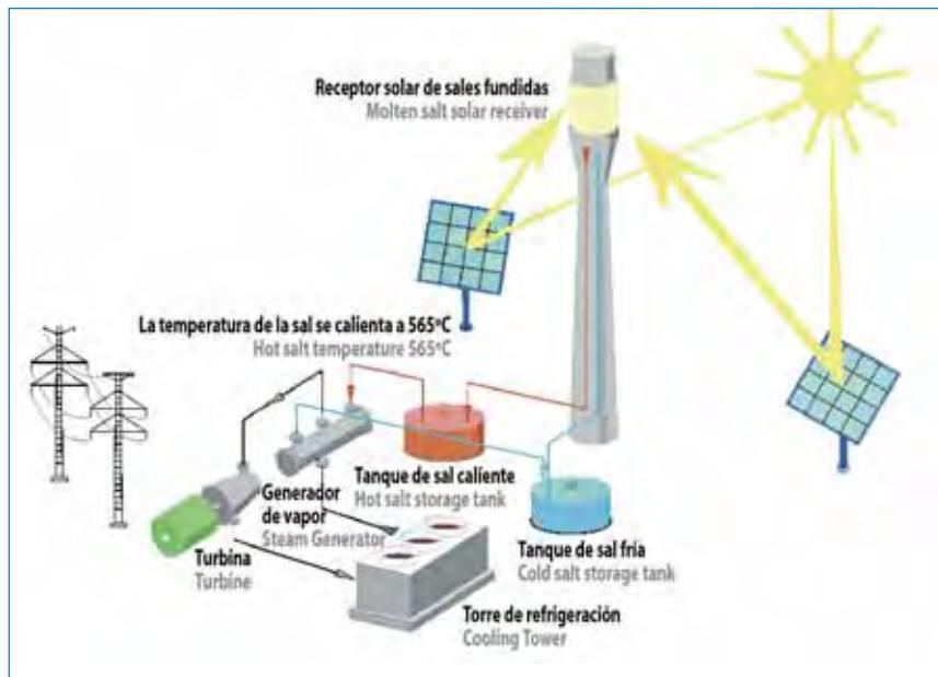
Esquema del concepto de Planta Gemasolar
