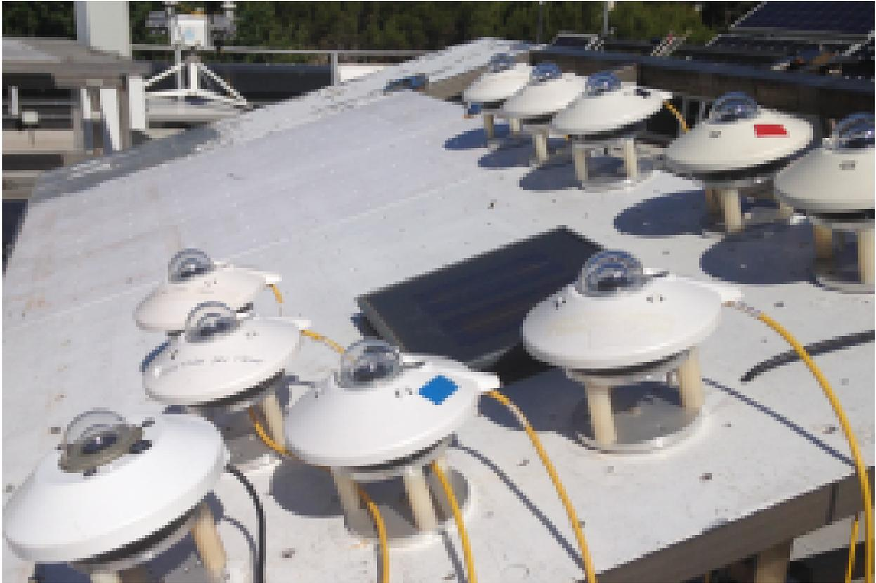
Figura 6.3: Piranómetros para la medida de la irradiancia solar global.
