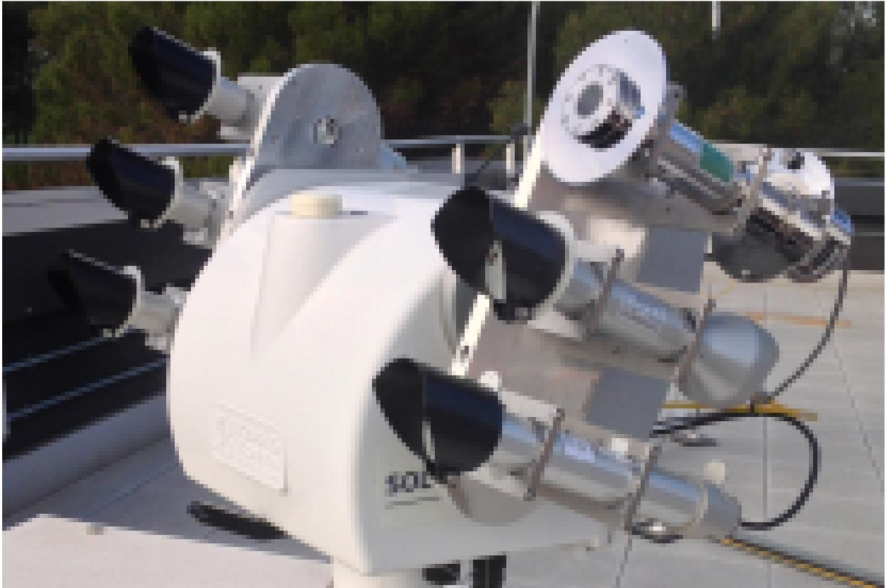
Figura 6.1: Pirheliómetros para la medida de la irradiancia solar directa.
