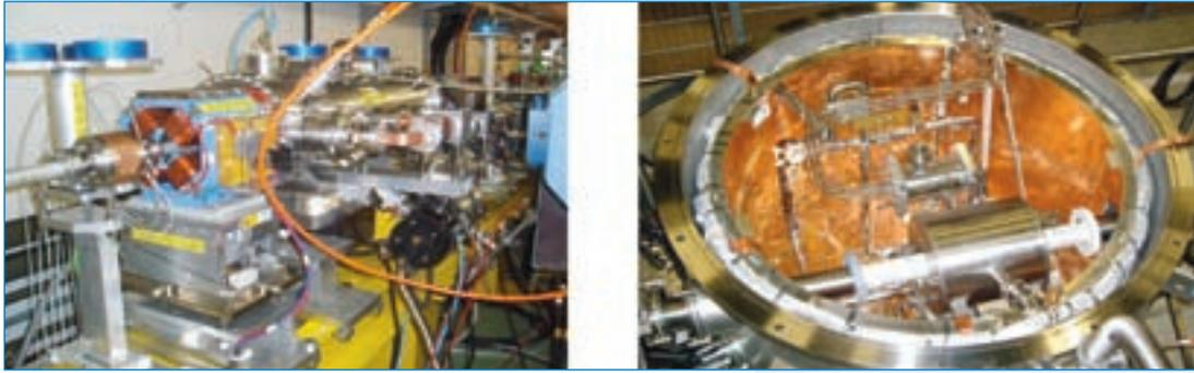
Figura 3. a) Unidad de PETS y una mesa móvil con un imán de focalización en primer término. b) Imán superconductor combinado para XFEL en la estación criogénica de ensayos.
