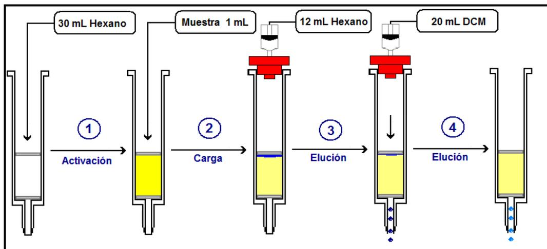
Figura II: Esquema de la SPE de los cartuchos Isolute EPH.
