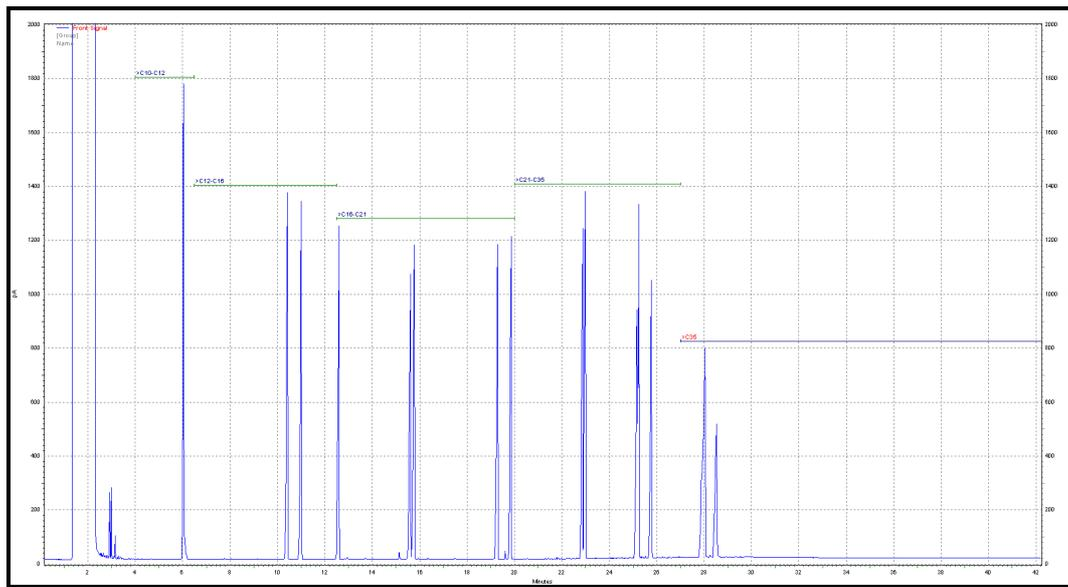
**Figura V:** Cromatograma de un patrón de hidrocarburos aromáticos de 60 µg mL<sup>-1</sup>.
