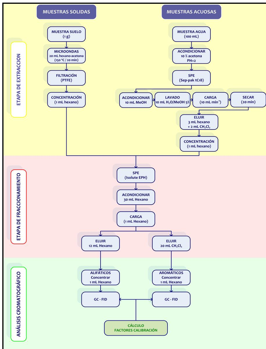
Figura I: Esquema del procedimiento analítico para determinar las fracciones de hidrocarburos y el contenido de TPH en muestras de agua y suelo.
