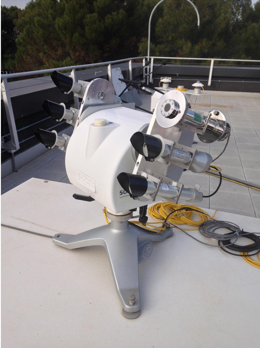
Figura 7.1: Pirheliómetros para la medida de la irradiancia solar directa.
