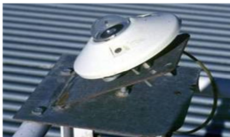
Figura 2.14. Foto de un radiómetro en las instalaciones de la PSA inclinado 37° sobre el plano horizontal.
