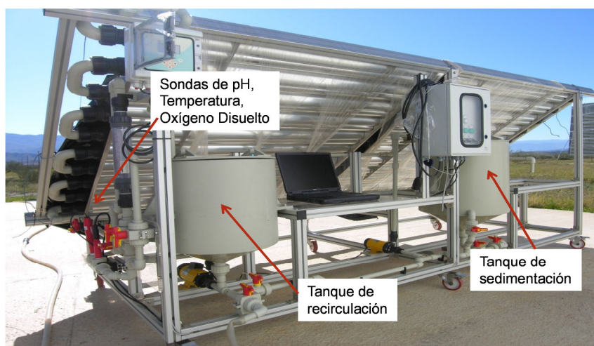
Figura 2.13. a) Diagrama de flujo del sistema, b) foto del reactor solar CPC de 60 L en la PSA (Almería, España) vista frontal y c) foto del reactor vista trasera.
