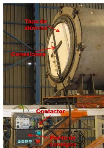
b) Identificación de los elementos del montaje
