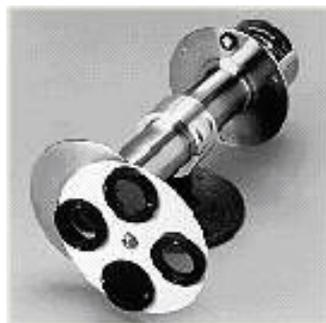
**Figura 3.5.** Pirheliómetro Eppley NIP
