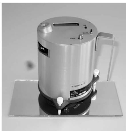
**Figura 3.38.** Reflectómetro portátil modelo 15R de la firma Devices&Services
