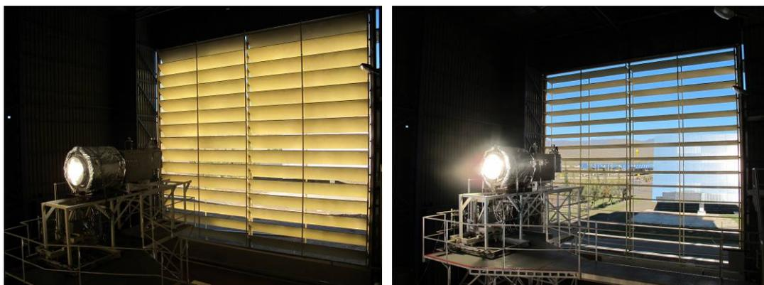
**Figura 3.4.** Atenuador en la posición “cerrado” (izquierda) y en la “totalmente abierto” (derecha)
