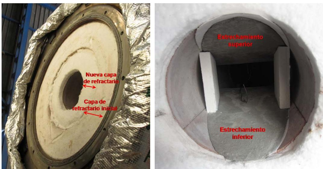
**Figura 4.24.** Métodos para modificar el volumen de la cámara de proceso: cambio de posición de la lámina deflectora (arriba), adición de una nueva capa de material refractario (abajo, a la izquierda) y adición de dos estrechamientos en la parte delantera (abajo, a la derecha)
