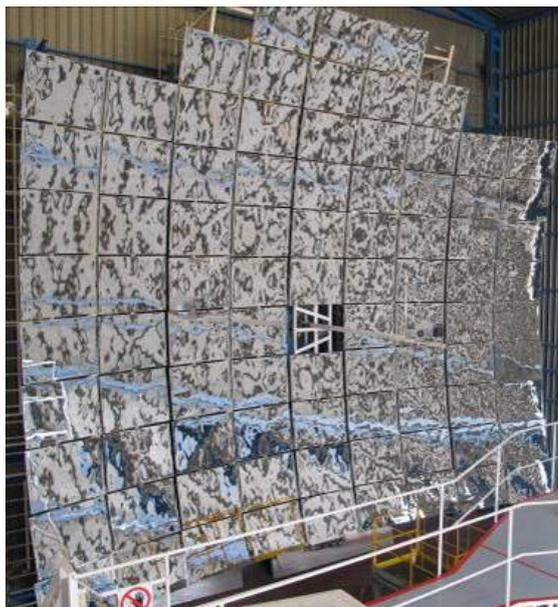
**Figura 3.3.** Concentrador del horno HS-60
