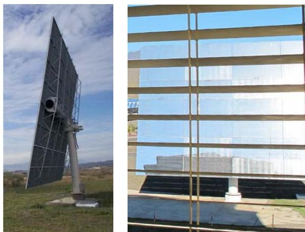
**Figura 3.2.** Estructura del heliostato HT-120 (izquierda) y vista desde el área de ensayos (derecha)
