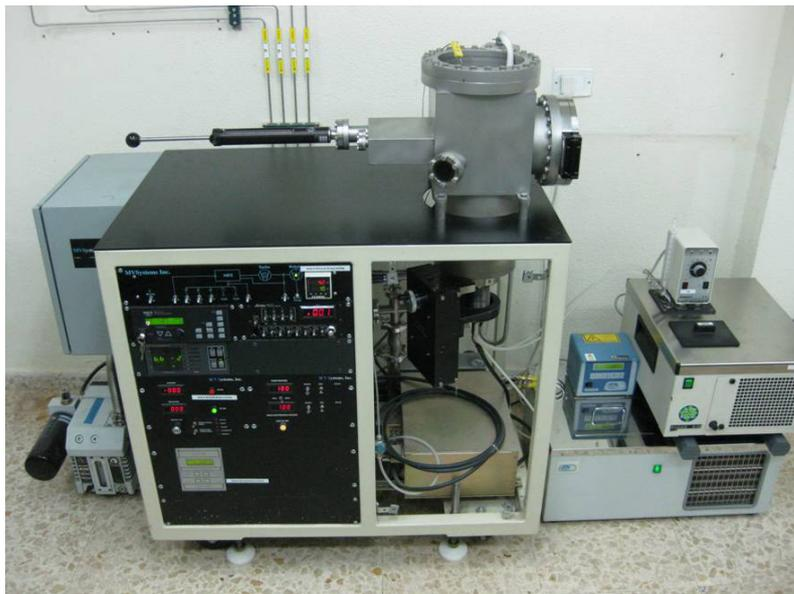
**Figura 2.4:** Imagen del pulverizador MVSystems para la fabricación de OCTs
