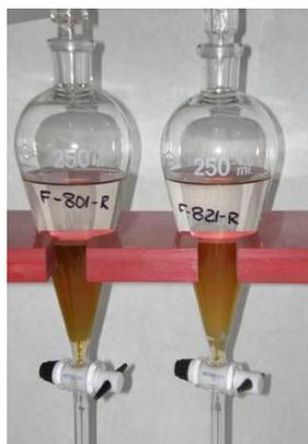
**Figura 3.2.** *Tratamiento con ácido sulfúrico concentrado de un extracto de lodos de EDAR.*
