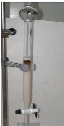
**Figura 3.3.** Purificación del extracto mediante separación cromatográfica en una columna de sílice ácida modificada.
