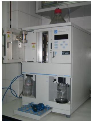
**Figura 3.1.** Equipo de extracción mediante fluidos presurizados ASE 100.
