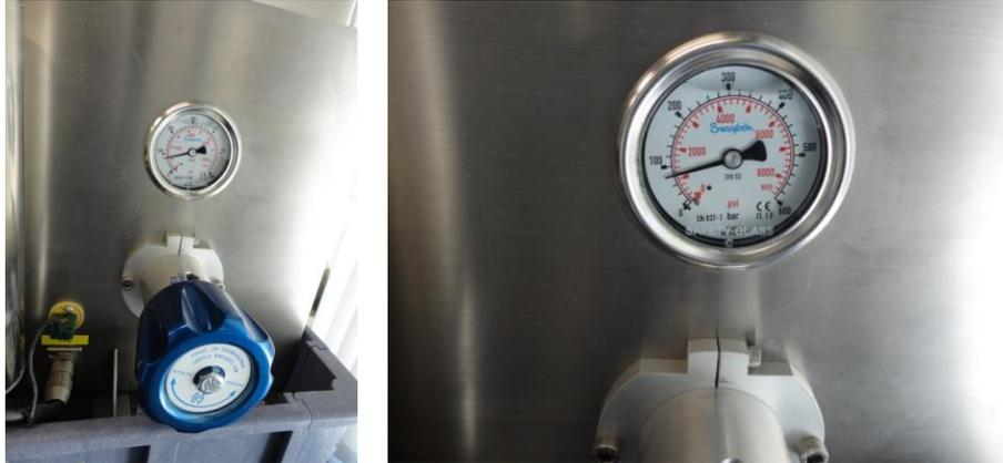
Imagen 5: Válvula de contrapresión a 80MPa
