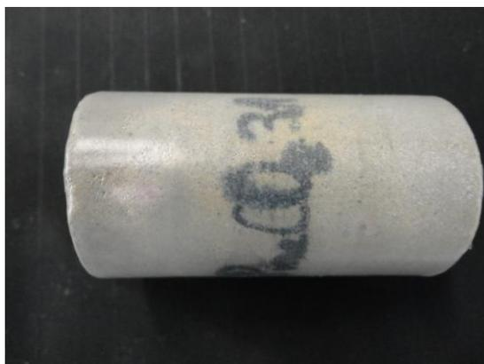
Imagen 3: Imagen de la muestra, objeto de ensayo, con el plástico termo-retráctil colocado
