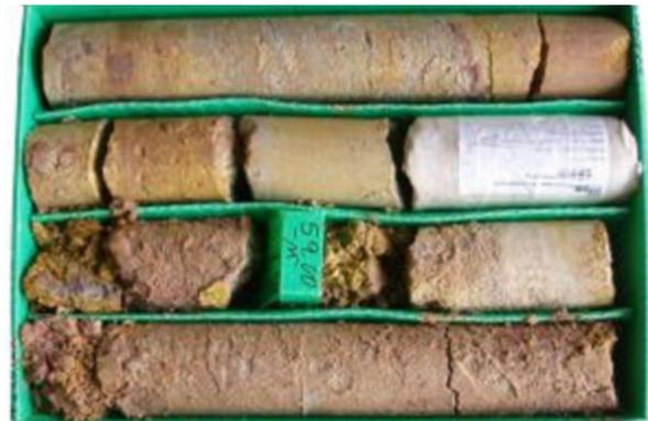
FIGURA 2. Sondeo SD-1 (Tejada - Burgos). Testigo de sondeo muestreado - Caja 24 - 55,15 - 59,85m de profundidad.
