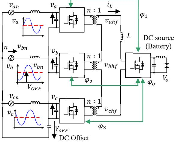
Fig. 2. The QAB 3P AC-DC converter
