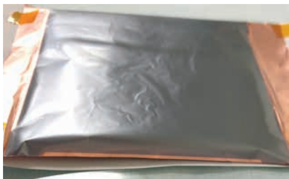
Fig. 3. Lámina de silicio amorfo hidrogenado crecido por PECVD, en un área de 10cmx10 cm, sobre una lámina de cobre.
