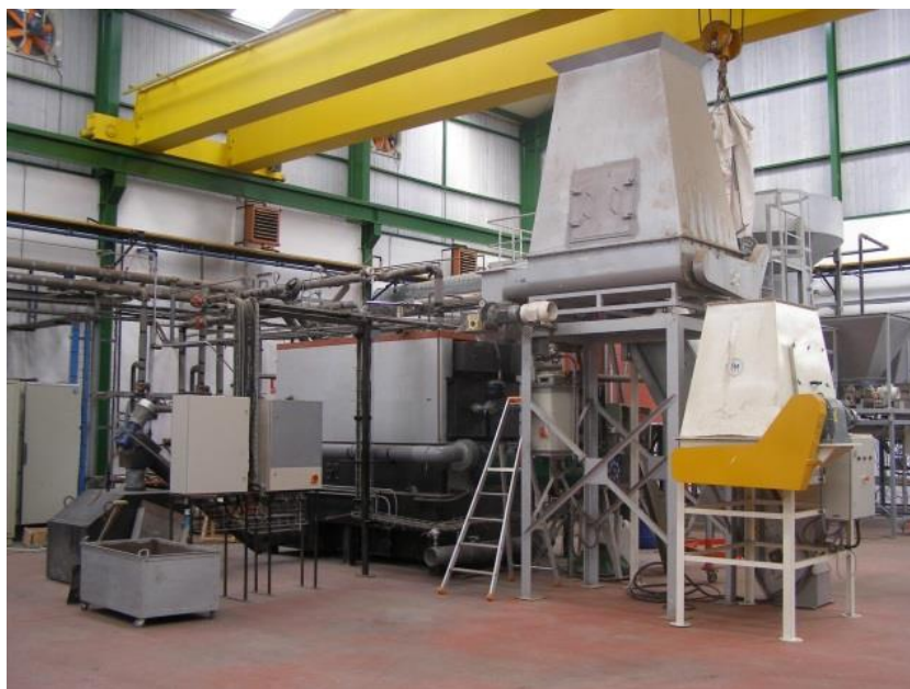
Figura 6. Planta de combustión de parrilla móvil de 500 kW, en CEDER-CIEMAT.
