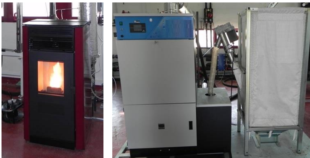
Figura 12. Estufa (izquierda) y caldera (derecha) utilizadas en los ensayos.
