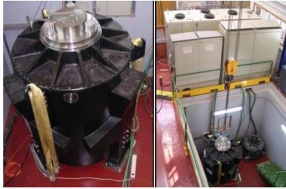
Figura 6. Volante de inercia durante las pruebas en el laboratorio de sistemas de potencia.
