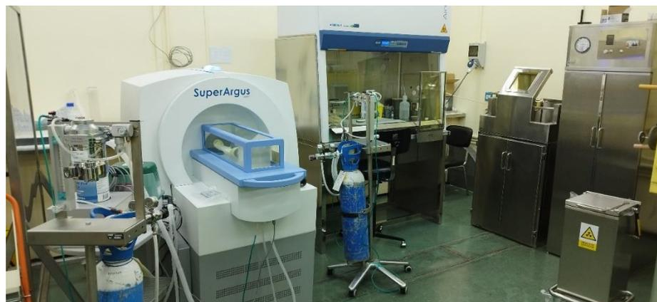
Figura 9. Imagen del laboratorio AAA. De izquierda a derecha: sistema de anestesia, equipo microPET/CT, cabina de flujo laminar con pantalla de cristal plomado, pantalla plomada para extracción de dosis y armario y papelera blindados.
