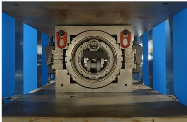
*Figura 12. Fase de montaje del dipolo exterior. Se pueden observar las cuatro bobinas que conforman los dos dipolos, los collares metálicos que las mantienen en su posición y el utillaje para su cierre con la prensa.*
