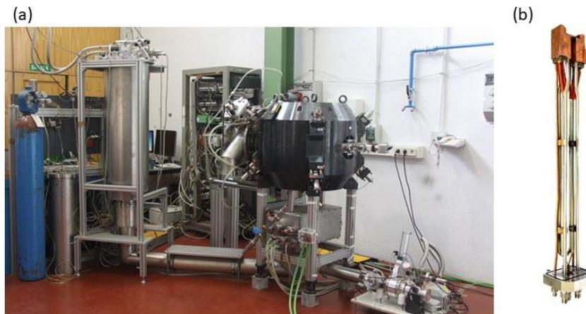
Figura 8. (a) Sistema ciclotrón completo. (b) Fuente de iones.
