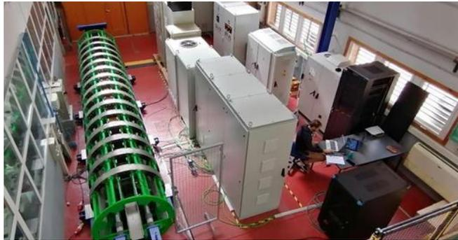
Figura 5. PTO de SEA-TITAN durante las pruebas en el laboratorio de sistemas de potencia.
