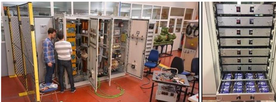
Figura 7. Convertidores electrónicos y supercondensadores durante los ensayos en el laboratorio de sistemas de potencia.
