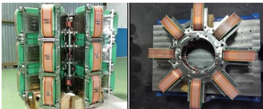
Figura 4. Bobinas de la parte móvil (activa) del PTO de SEA-TITAN.
