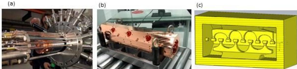
Figura 7. (a) fuente de iones  $C6+$ . (b) RFQ. (c) Diseño cavidades IH.
