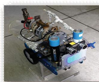
**Fig.1** Aplicación móvil, mbot, con pila de hidrógeno ("stack" 4 monoceldas AB-PEMFC).
