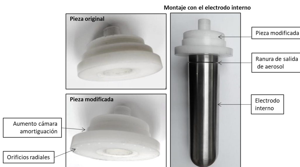
Figura 11. Pieza de salida del gas de exceso original, modificada, y su montaje junto al electrodo interno del DMA CIEMAT.
