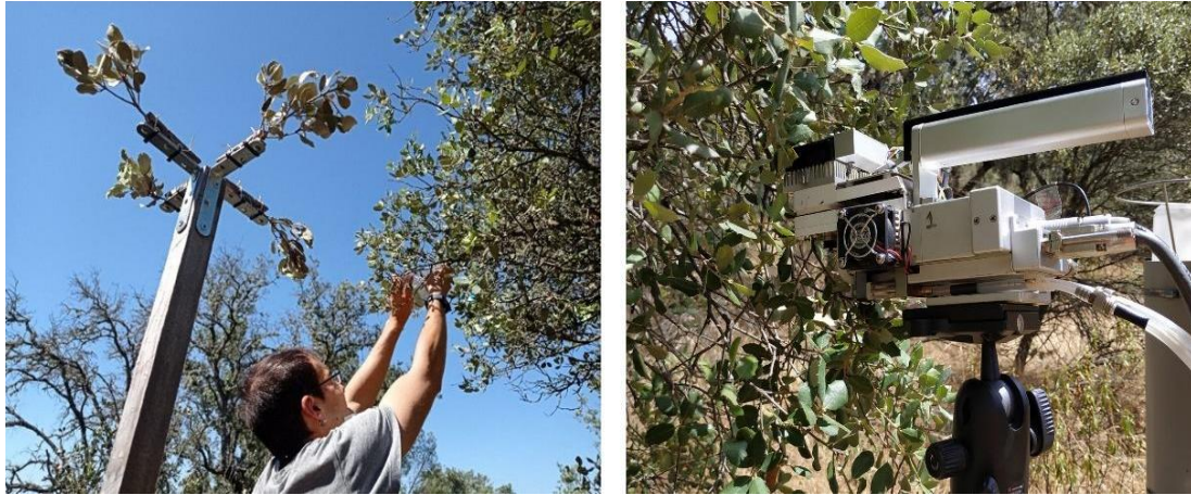
Figura 12. En la imagen de la izquierda se muestra la medición del depósito seco mediante la utilización de ramas liofilizadas colocadas en el poste y ramas naturales. En la imagen de la derecha se muestra las mediciones de intercambio gaseoso de las encinas mediante el uso de un equipo portátil de fotosíntesis tipo LI-COR 6400.
