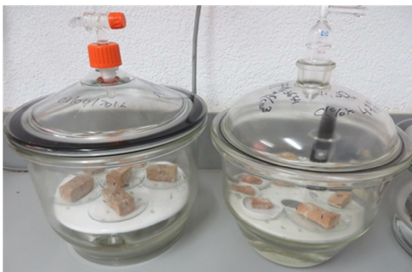
Figura 3: Muestras en desecadores para determinación de la curva de retención
