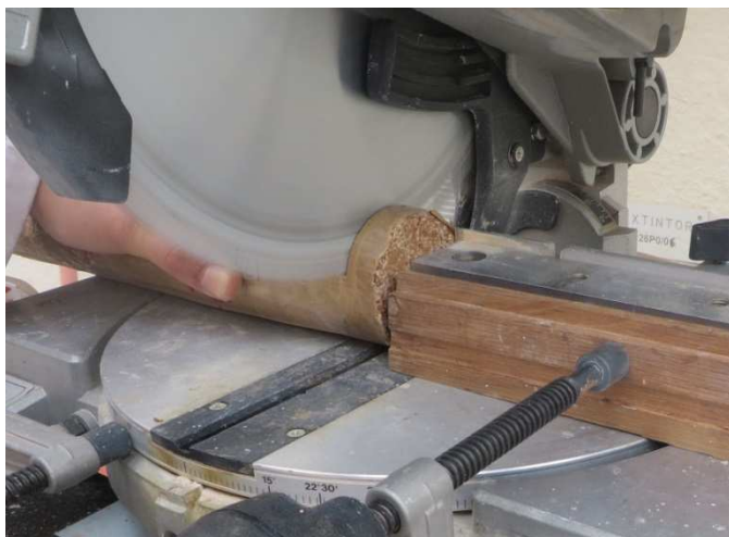
Figura 2: Corte de secciones de los testigos con sierra de disco
