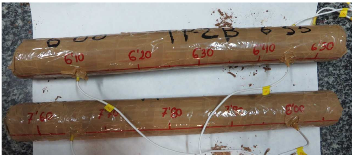
Figura 1: Medida con psicrómetros de la succión total de testigos
