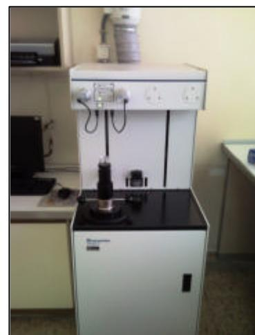
Foto 1. .- Laboratorio de Caracterización Petrofísica del Ciemat. Porosímetro de inyección de Hg, Autopore IV – 9500 - Micromeritics
