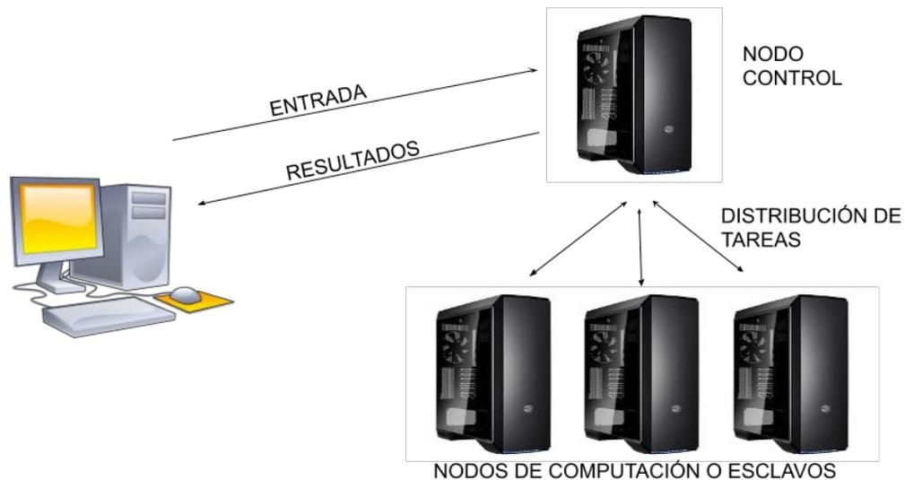
Ilustración 57 Representación de computación GRID
