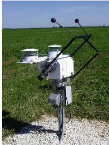
**Figura 2. Seguidor solar**
