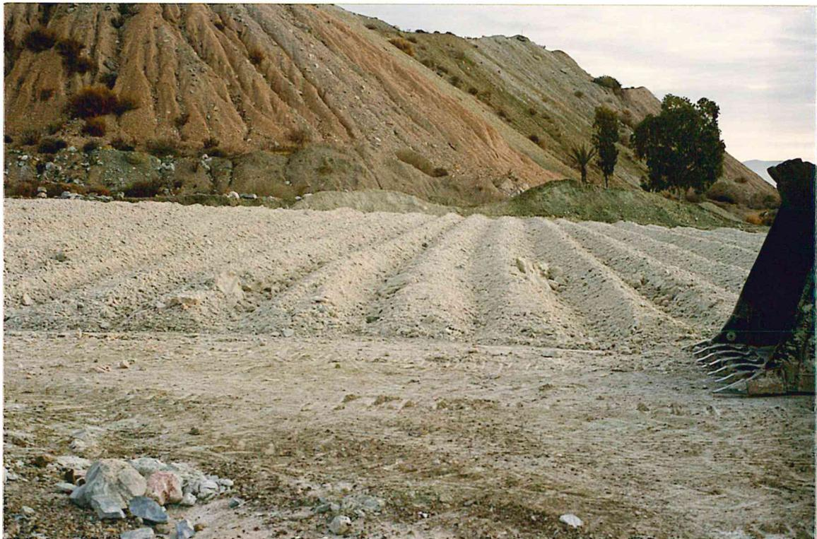
Fig. 16: Aspecto de la parva de bentonita en el tiempo de secado
