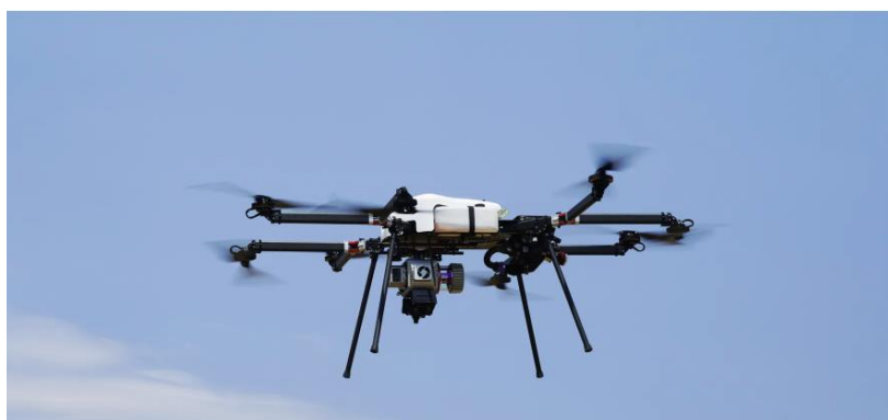
Figura 26. Dron híbrido con motor de combustión [45].
