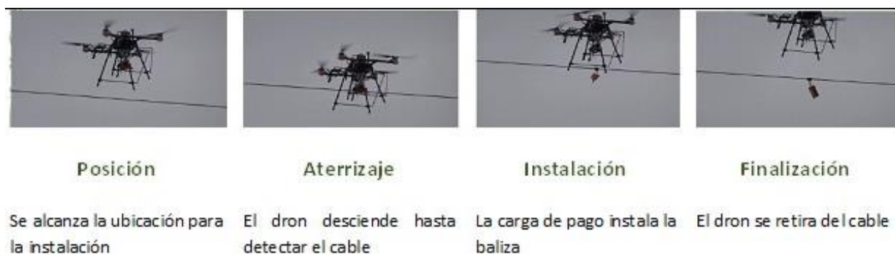
Figura 33. Dron para instalación de balizas avifauna en líneas de distribución eléctrica en servicio [62].
