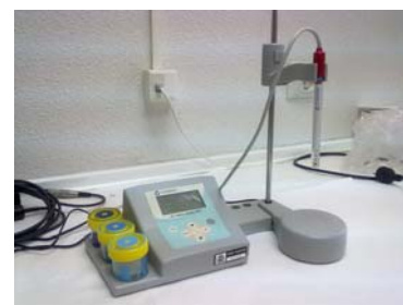
Figura 12. Conductímetro Crison EC-Meter Basic 30 +
