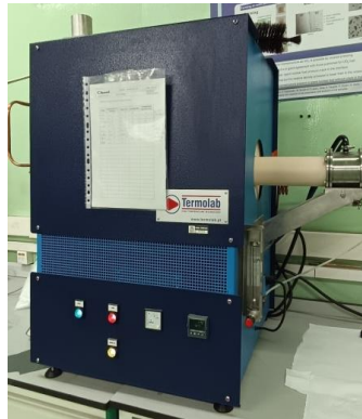
Figura 10 Horno tubular Termolab TH-1700 utilizado para tratamientos térmicos controlados.
