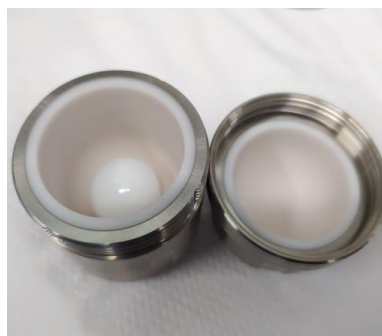
Figura 6 Molino de bolas de alta energía, con su respectivo compartimento para los polvos.
