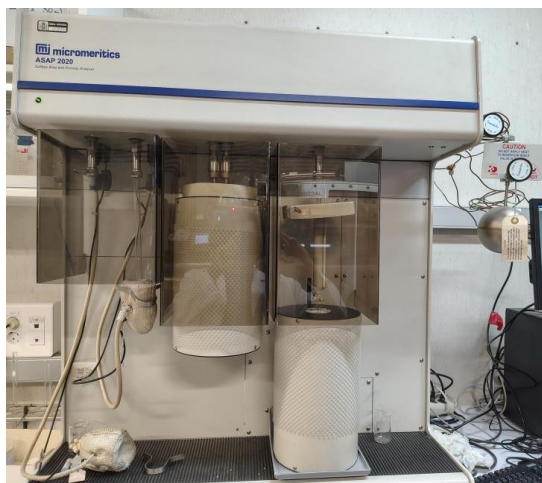
Figura 4. Equipo Micromeritics ASAP 2020 utilizado para análisis BET.
