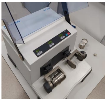
Figura 6 Molino de bolas de alta energía, con su respectivo compartimento para los polvos.
