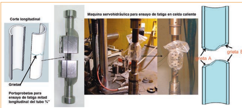
Figura 3. Segmento del tubo cortado de forma longitudinal en dos medias cañas conteniendo las grietas y sometido a fatiga para la obtención de las superficies de fractura correspondientes.
