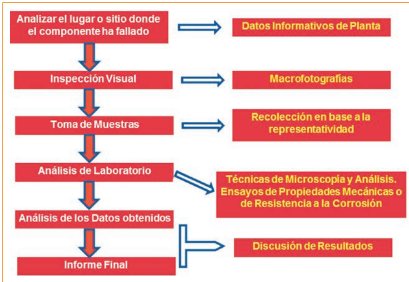
Figura 1. Diagrama de flujo de la metodología a seguir en un análisis de fallo de un componente.
