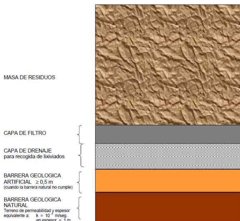
Figura 2. Barreras de protección mínimas para Vertederos de Residuos Inertes (sol. de referencia)
