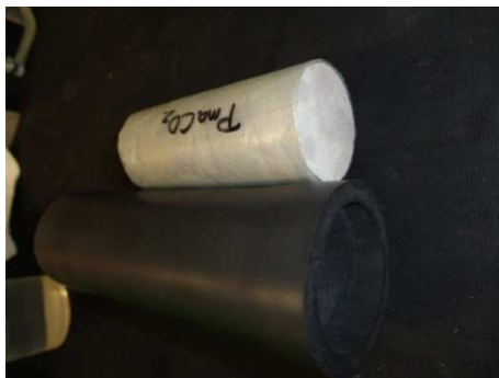
Imagen 2: Colocación de la muestra en el caucho de confinamiento
