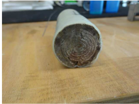
Imagen 13: Corte del caucho que envolvía a la celda para recuperación íntegra de roca
