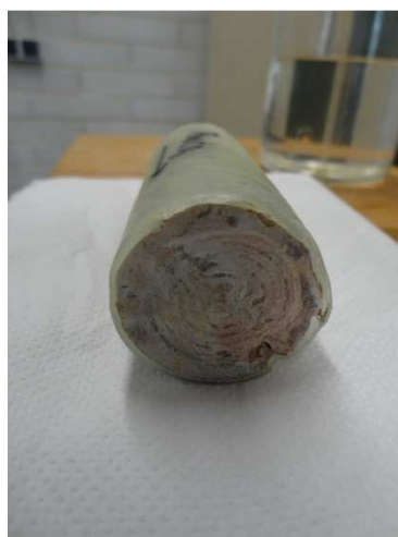
Imagen 14: Estado de la roca tras finalizar el ensayo
