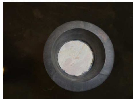
Imagen 2: Colocación de la muestra en el caucho de confinamiento
