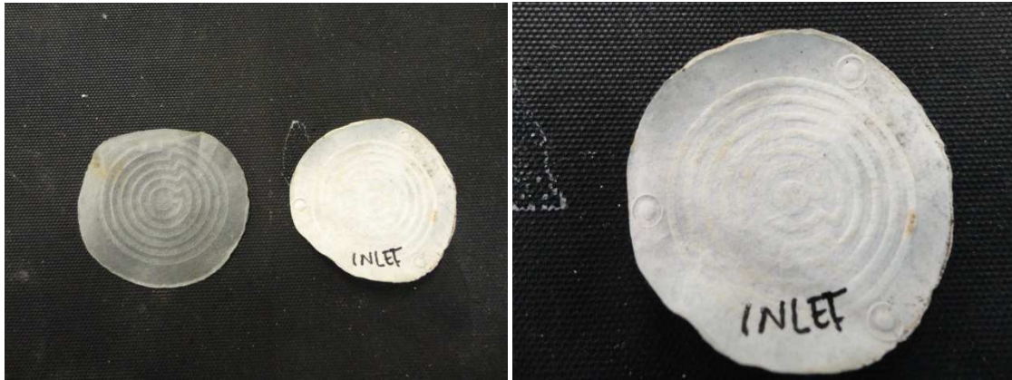
Imagen 7: Estados de los filtros tras su retirada de los extremos de la muestra.
