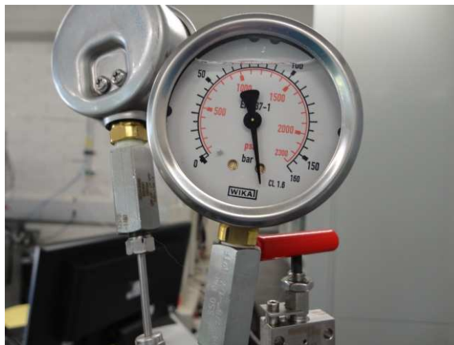
Imagen 5: Manómetro en la línea de inyección de fluidos de la celda
