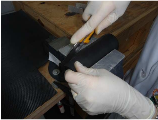
Imagen 13: Corte del caucho que envolvía a la celda para recuperación íntegra de roca
