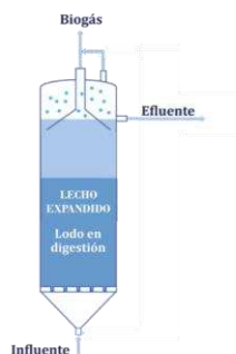
Figura 5.15: Esquema de un digestor de Lecho Expandido. Fuente: Carreras (2013).
