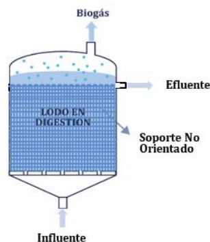
Figura 5.12: Esquema de un digestor de Filtro No Orientado. Fuente: Carreras (2013).
