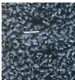
Ilustración 5: Soporte fijo utilizado en digestores españoles.
