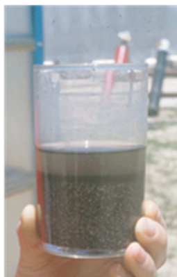
Ilustración 6: Soporte móvil utilizado en digestores españoles.
