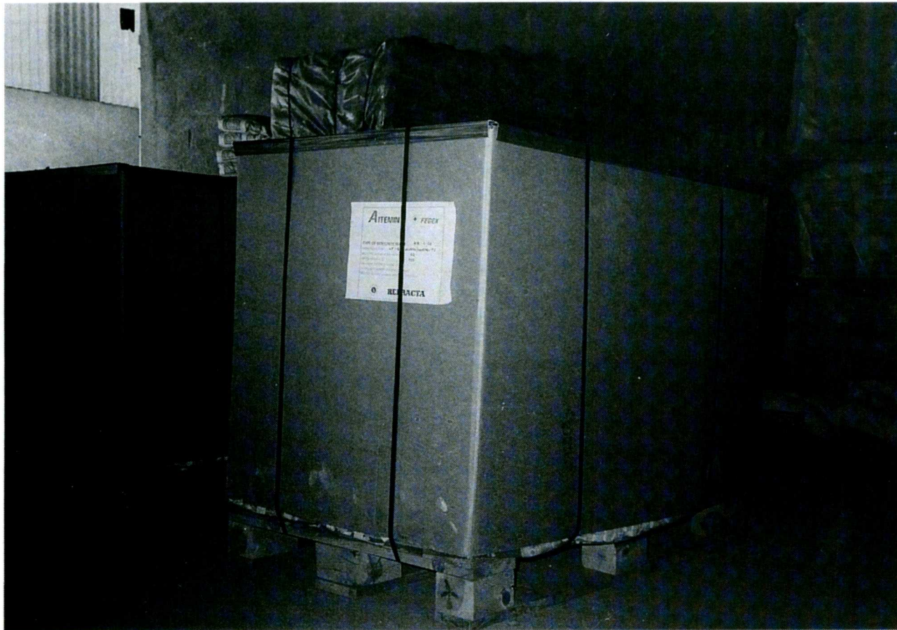
Figura 5.17: Embalaje de bloques terminado. Obsérvese la base del embalaje (pallet), los protectores de aristas superiores, el flejado, el etiquetado y el recubrimiento termorretráctil del conjunto.
