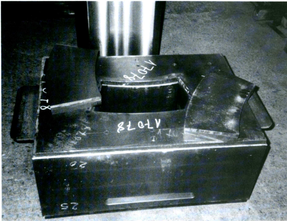
Figura 5.10: Vista de la matriz de un molde. Sobre la matriz están situados los dos punzones del molde.
