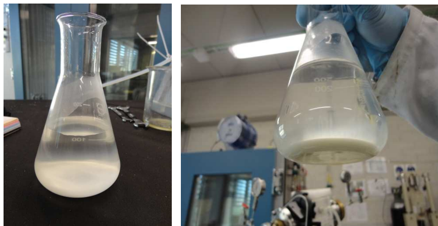
Imagen 12: Producción de salmuera que atraviesa la muestra
