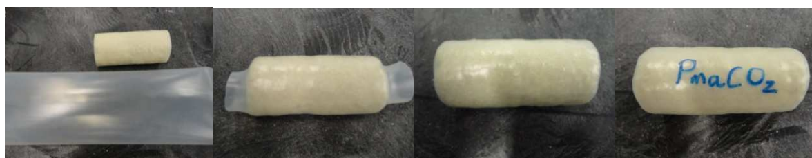
Imagen 2: colocación del plástico termo-retráctil
