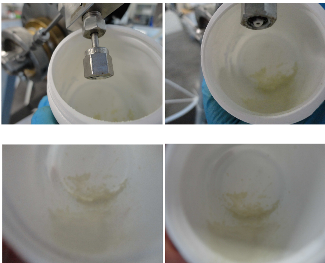
Imagen 17: Producción de CO 2 , salmuera y parte de roca arrastrada por la salmuera y el CO 2 .
