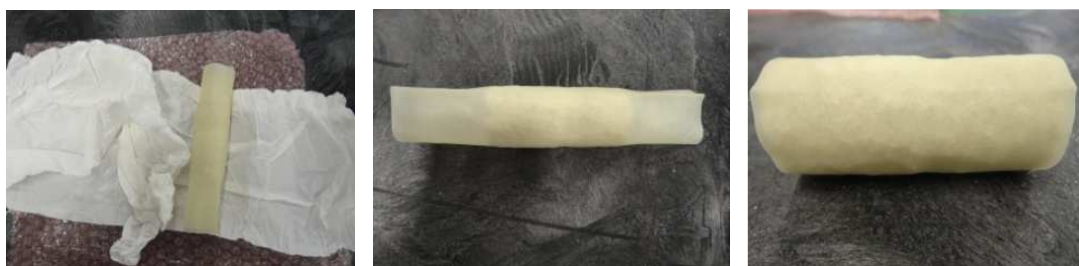
Imagen 1: Recepción de muestra y corte de extremos sobrantes de camisa de silicona
