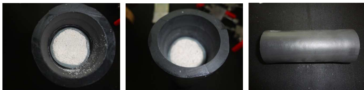
Imagen 9: Ubicación de la muestra en el caucho
